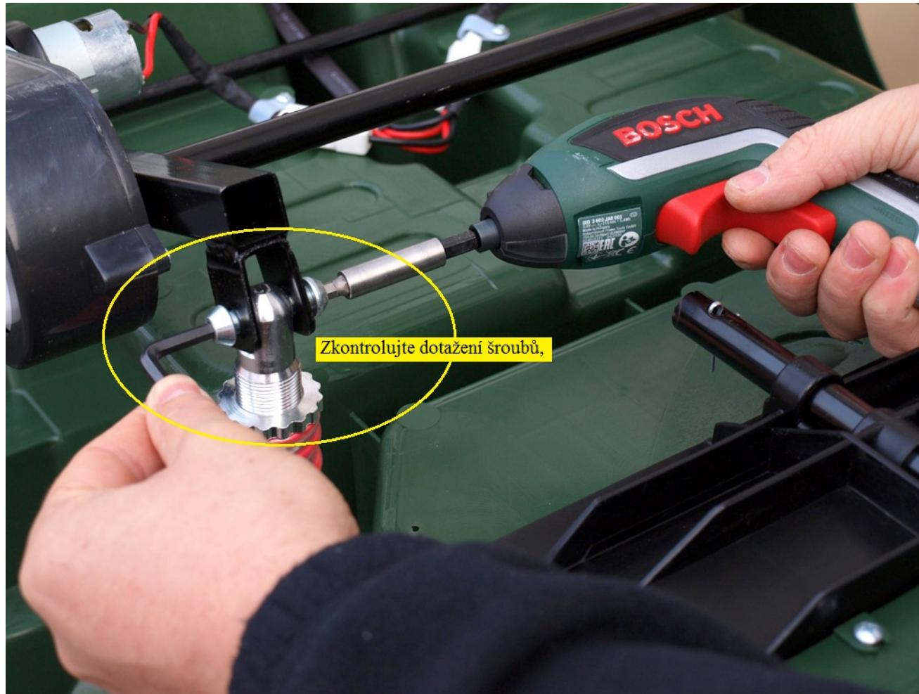
Zkontrolujte dotažení šroubů,
