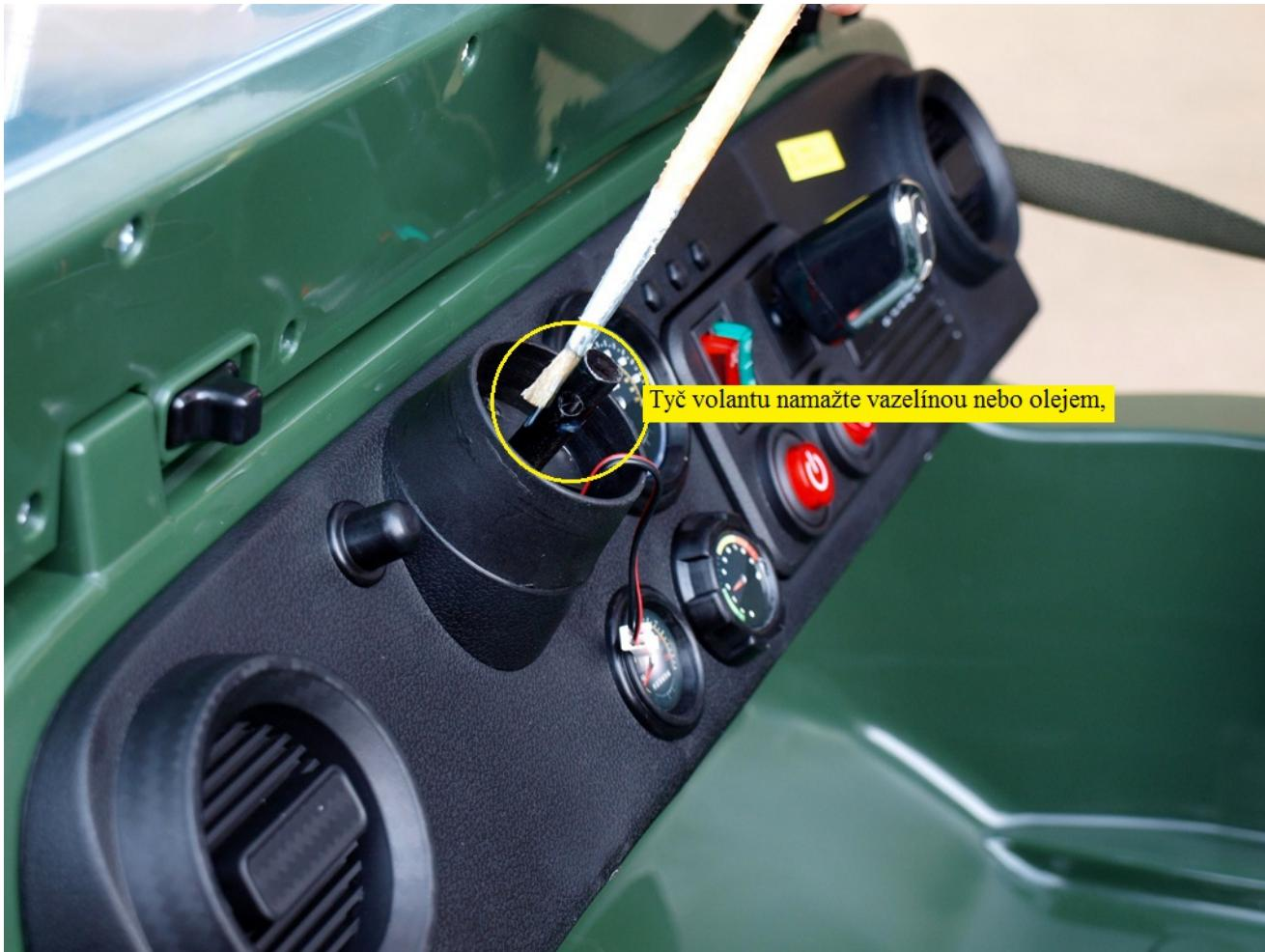
Tyč volantu namažte vazelinou nebo olejem,
