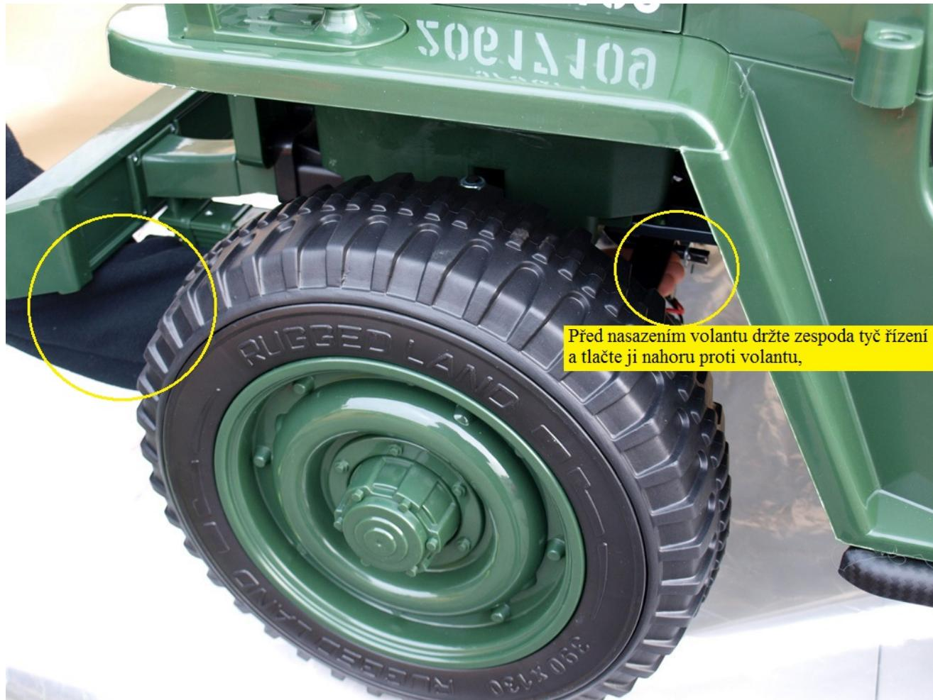
Před nasazením volantu držte zespoda tyč řízení a tlačte ji nahoru proti volantu,
