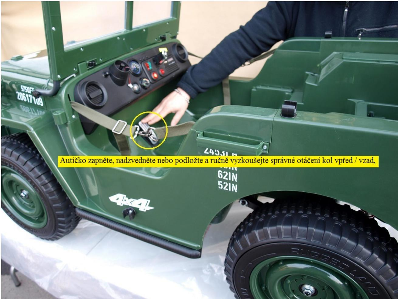
Autíčko zapněte, nadzvědněte nebo podložte a ručně vyzkoušejte správné otáčení kol vpřed / vzad,
