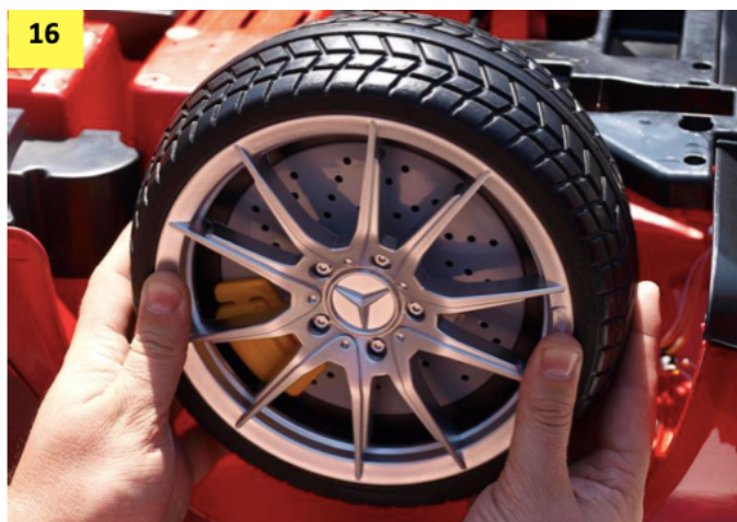
Obr. 15-16: Nyní na všechna kola nasadte poklice. Pozor: poklice je lepší nasazovat nahřáté (stačí ponechat na topení, slunci nebo použít fén). Po nahřátí půjdou poklice snadněji nasadit.
