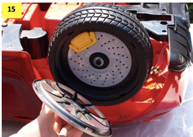
Obr. 17: Osu řízení namažte vazelínou nebo olejem.
