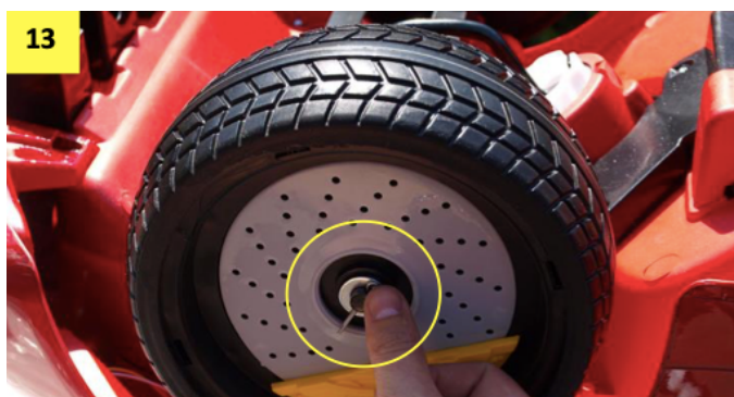
Obr. 15-16: Nyní na všechna kola nasadte poklice. Pozor: poklice je lepší nasazovat nahřáté (stačí ponechat na topení, slunci nebo použít fén). Po nahřátí půjdou poklice snadněji nasadit.
